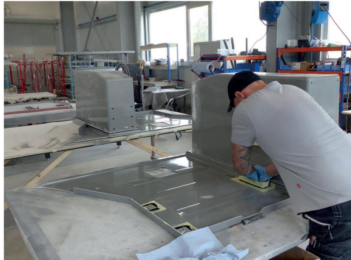
Auftrag von PU-Isolationsschäumen / Einbau von Einlegeteilen, wie z.B. Halter, Gitter, Winkel, Schamiere, Griffe / Montage von Baugruppen
