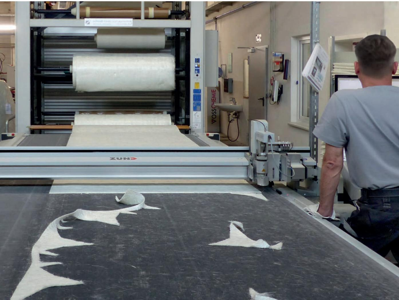
CNC-Zuschnitt der Glasfaser- und Corematten / Trennmittelauftrag in die Produktionsform / Einspritzen der farbigen Gelcoatschicht
