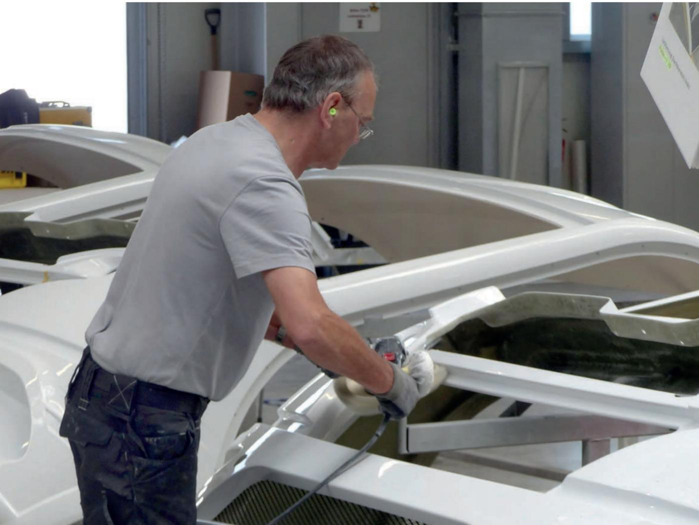
Polieren von Formteilen mit finaler Gelcoat-Oberfläche / Lackieren von Bauteilen nach Kundenwunsch - auch mehrfarbig
