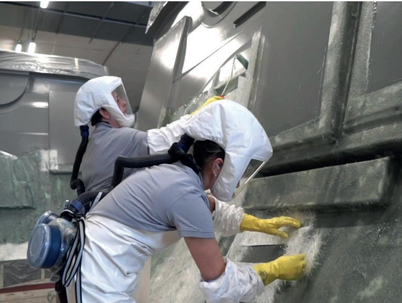
Handlaminat: Einlegen der Fasermatten / Aufrollen des Harzes / Faserspritzen: gleichzeitiges Aufsprühen von Fasern und Harz
