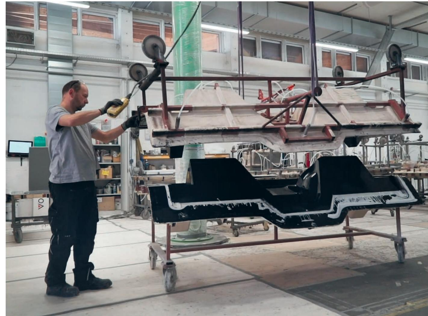
RTM: Einlegen der Matten in Form / Schließen der Gegenform / Injektion des Harzes / Öffnen der Form und Entnahme des Bauteiles
